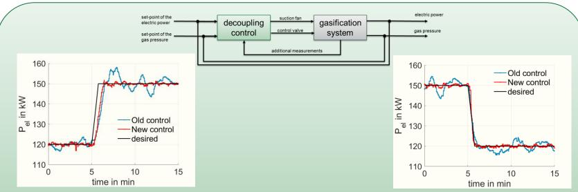
C. Hollenstein: Erhöhung der Flexibilität von Biomasse-Festbettvergasern durch modellbasierte Regelungsstrategien: Methoden und praktische Verifizierung
