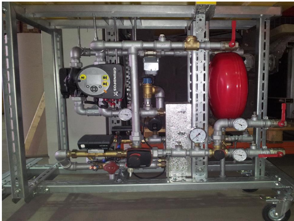
Abbildung 5: Mobiler Hydraulikteststand zur Simulation von typischen Lastzyklen und raschen Rücklauftemperaturänderungen.
